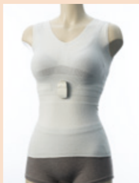
自社初のIoT商品「hamon」。"着る"だけで着用者の心拍情報からストレス、暑熱リスク、眠気などの体調の可視化を行う
