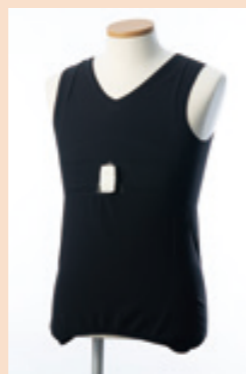
自社初のIoT商品「hamon」。"着る"だけで着用者の心拍情報からストレス、暑熱リスク、眠気などの体調の可視化を行う
