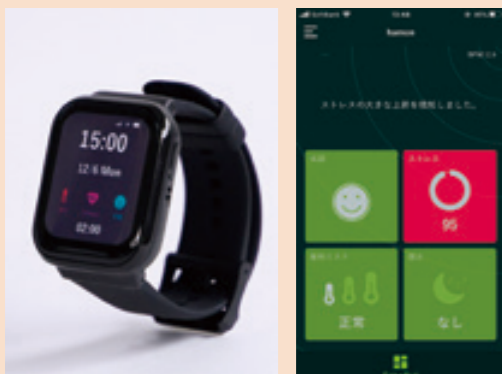
従業員の生体情報を読み取り、ストレス、眠気、暑熱リスクなどを一元管理できるスマートウォッチ「MITSUFUJI O3」。LTE通信機能を搭載し、管理者のPC、スマートフォンに状態を通知する
